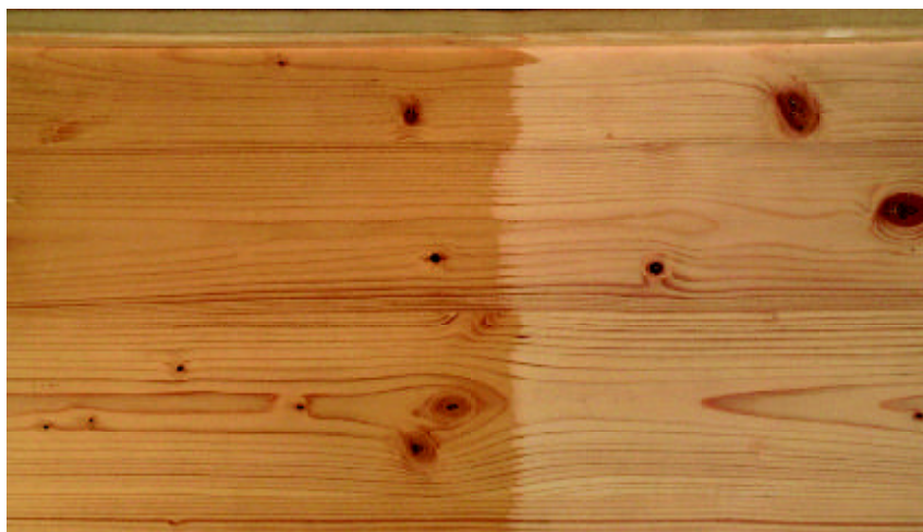
Fichtenbrett: Die rechte (hellere) Seite wurde mit „Pegma-Color“ vorbehandelt; anschließend wurde die Gesamtfläche mit Allzwecklasur nachbehandelt
